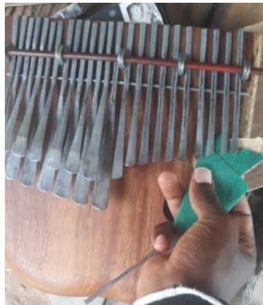
Figura 13: Eliminação das ranhuras nas lamelas. Fonte: Captação própria.
